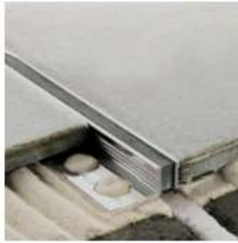
| Junta estructural con perfilera sup. máx. 25 m2 coincidente con la junta de sustrato.
